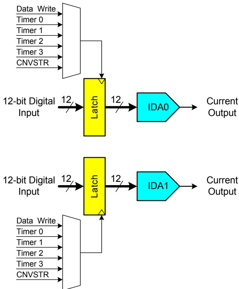
**Figure 1.8. IDAC Block Diagram**
