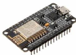
NodeMcu Lua ESP8266 ESP-12E
